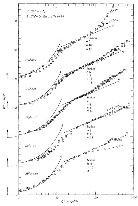
FIGURE 9a.  $\hat{u}^+ - \hat{y}^+$  profiles using  $v^*$  (note shifted origins).
